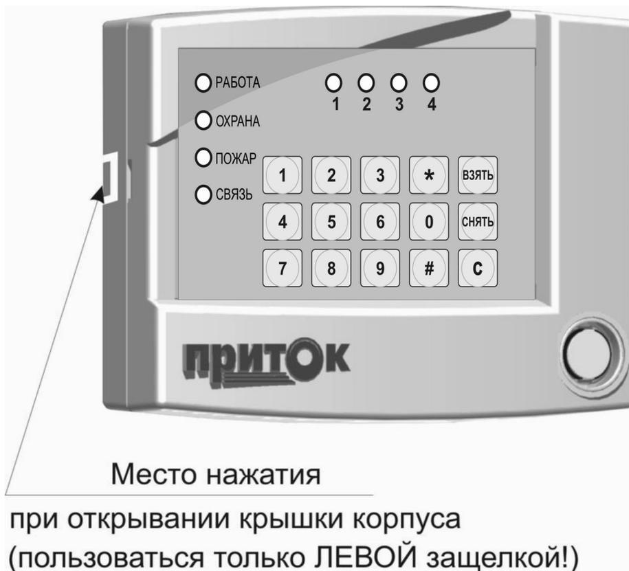
Рисунок 1. Вскрытие корпуса контроллера.
